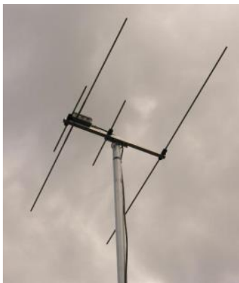
2 + 2 elementi Yagi per 2m (radiatore alimentato) e 70cm (radiatore Open Sleeve)
