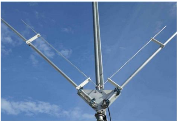
Dipolo 6m Open Sleeve accoppiato a “Cornuta” 10-40m
